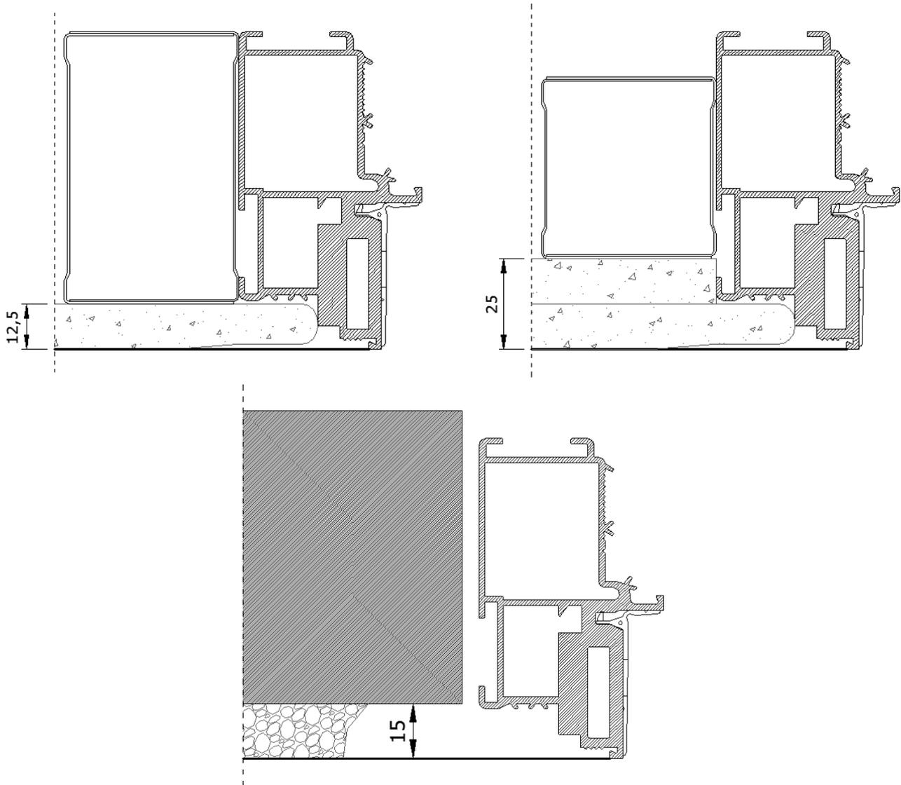
Normalmente il riferimento del telaio al filo parete rappresenta un adeguato allineamento verticale. Se necessario, per imperfezione della parete di appoggio, correggere il posizionamento dei montanti per recuperare il piombo su entrambi i lati. Durante le operazioni di posizionamento è utile utilizzare dispositivi provvisori fissaggio come zeppe contrapposte o altro.
