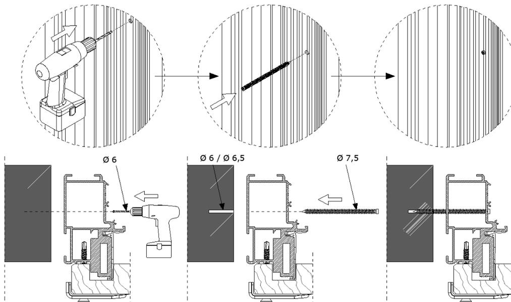
**NOTA BENE:** anche nel caso di montaggio su intonaco occorre procedere con il fissaggio a vite e non con il tradizionale fissaggio ad umido con zanche.
