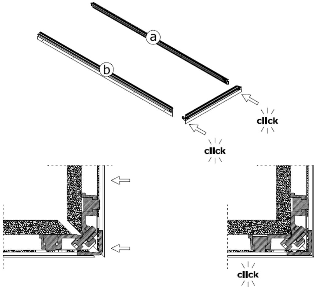
Per assicurare la corretta messa in squadra del telaio durante le operazioni di installazione è importante completare l'assemblaggio con i traversi temporanei in dotazione. Verranno rimossi a fissaggio ultimato.
