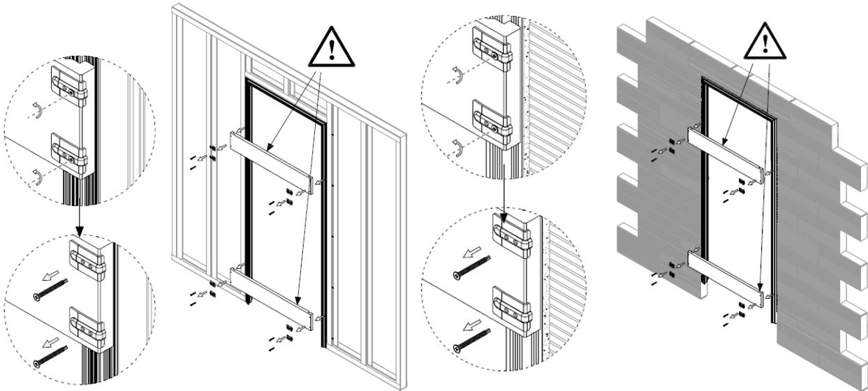
Un volta tolto i distanziatori terminare la finitura della muratura con lastre di cartongesso (di tipo "F") o intonaco.
